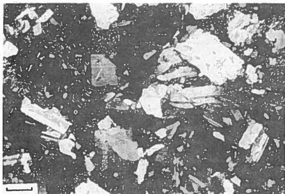
FIG. 8. Toba de cristales, brechosa (C-312), con cristales de plagioclasa torcidos, fallados y con extinción ondulosa (Perfil 3, Miembro B). Barra = 0,5 mm.
