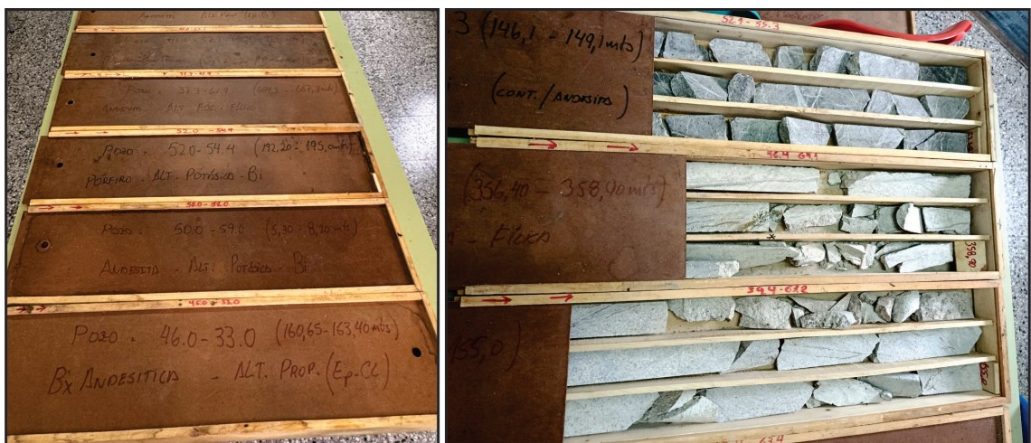
FIG. 5. Cajas portatestigos de madera y tapas de aglomerados con las rotulaciones originales (izquierda). Secciones con baja recuperación por fragmentación de testigos durante la extracción (derecha).
