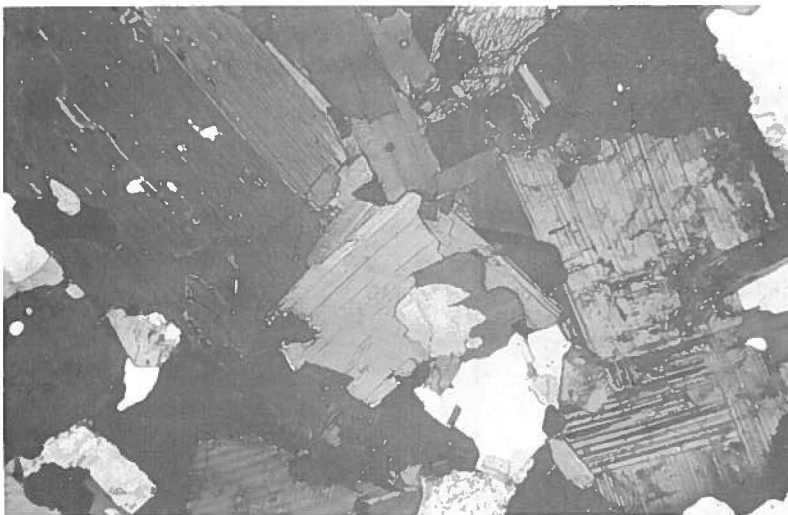
Foto 3. Unidad Guanta: Tonalita de grano grueso; plagioclase, hornblenda y biotita, cuarzo intersticial (Muestra N-BT-302).
