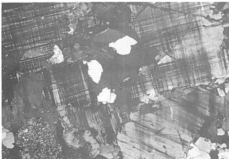
Foto 5. Unidad El Volcán: Monzogranito cataclástico de grano grueso; feldespato potásico con maclas de microclina, plagioclase alterada; cuarzo deformado granular y biotita cloritizada (Muestra HC-29).
