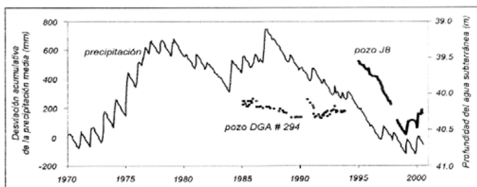
FIG. 11. Desviación acumulativa de la precipitación media en Ujina y Collacagua comparada con los niveles de aguas subterráneas en la Pampa del Tamarugal. Datos J8 de DGA; datos DGA # 294 de JICA (1995) trazados a la misma escala, pero ajustados para la altura.
