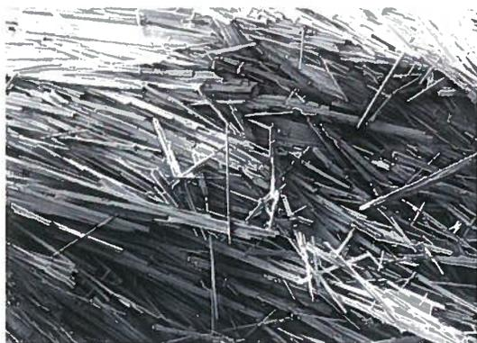
FIG. 3. Cristales de ulexita mostrando su típica estructura en fibras. El grosor de cada fibra es del orden de 0,5 a 2  $\mu$ .
