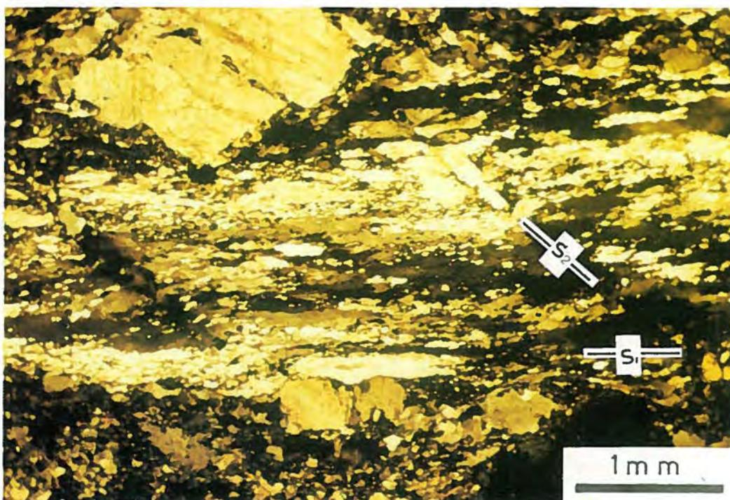
FIG. 9. Foliación milonítica S1 dada por granos de cuarzo deformados (D1), posteriormente crenulados por una segunda deformación (D2), que generó un clivaje de crenulación S2. Superunidad Gastre.
