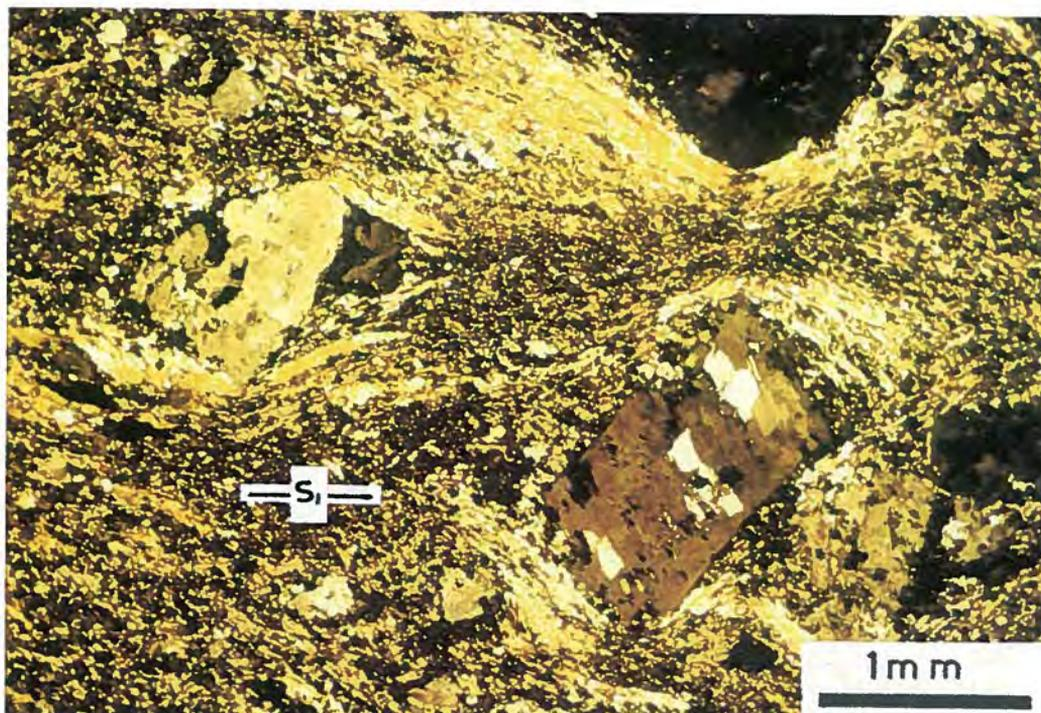
FIG. 6. Cristales de feldspatos rotados y con sombras de presión asociadas en una milonita de volcanita. S1: foliación milonítica. Corte no orientado.
